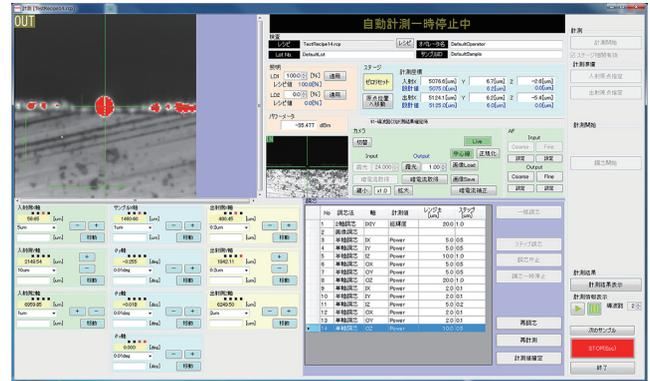
1550nm の光源を使用、シリコンフォトニクス導波路の出射側からの光を観察しています。また、赤外ハロゲン同軸落射照明を使用し、導波路出射端面の顕微鏡画像を観察しています。
