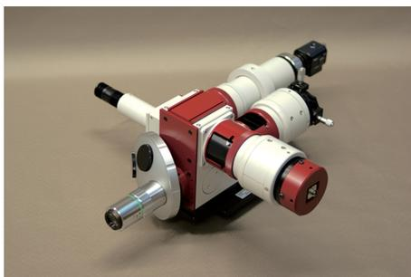
○偏光依存性対策型高機能光計測用光学系 M-Scope type I/PF
