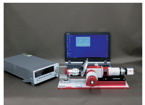
【NFP&IVL 測定装置】 当社製高機能 NFP 計測光学系 M-Scope type S の手動レボルバに IVL 測定モジュール PMD002/IVL の検出器ヘッドを装着可能です。
