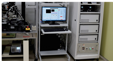
●システム制御装置 システム全体制御 画像処理・データ処理解析 実装組立工程レシピ管理
