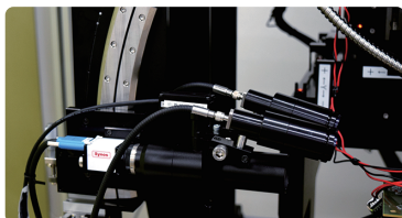
●側方観察光学系・画像観察装置 ファイバアレイ把持位置観察 パッシブアライメント用照明 UV 接着用ニードル位置観察
